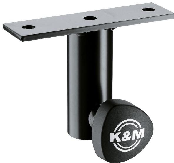
Aufsteckbar auf Boxenstative mit Rohr-Ø 35 mm. Passend für Boxen und Flugrahmen. Mit zwei Befestigungslöchern Ø 11 mm im Abstand von 115 mm und Arretierungsschraube für Stativbefestigung. Inkl. je 2 Stück Befestigungsschrauben M10 x 40 mm, Scheiben und Muttern.
