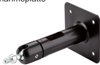
Der praktische Wand- und Deckenhalter mit 3/8" Gewindeanschluss wurde in der 2017er Version im Detail überarbeitet. Neu hinzugekommen ist ein Kabelausslass, der jetzt eine interne Kabelführung für verdeckte Installationen ermöglicht. Dank zweier Sonder-Gewindestifte und des mitgelieferten Sechskantschraubendrehers, kann das flexible Kugelgelenk exakt positioniert und fixiert werden. Die max. Belastbarkeit steigt somit auf 10 kg. Der Wandabstand wurde auf 160 mm verringert.
