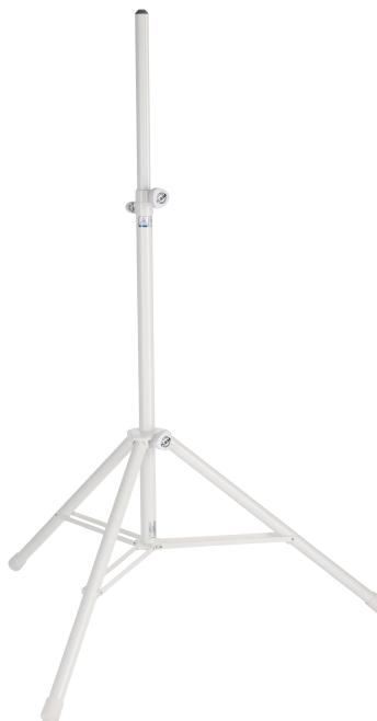
Das weltweit anerkannte Boxenstativ ? robust und langlebig. Alle Spannschellen sind aus hochwertigem Zinkdruckguss. Die Fußkonstruktion und die großen fest fixierten Parkettschoner sorgen für Standsicherheit und Stabilität. Zusätzliche Merkmale sind eine Auszugssicherung, der Stoßdämpfer im Grundrohr und eine komfortable Höhenverstellung mit Rastbolzen. Eine zusätzliche Aufsteckhilfe erleichtert die Boxenmontage.
