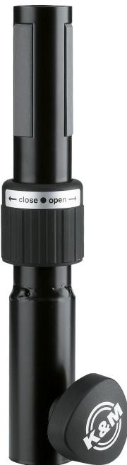
Aufsteckbar auf Boxenstative mit Rohr-Ø 35 mm, arretierbar mittels Klemmschraube. Mit integriertem, patentiertem Spreizdorn für festen, spielfreien und fixierbaren Sitz der Box. Die Spreizbacken aus Kunststoff sorgen für eine resonanzarme Verbindung zwischen Box und Stativ. Stahl.
