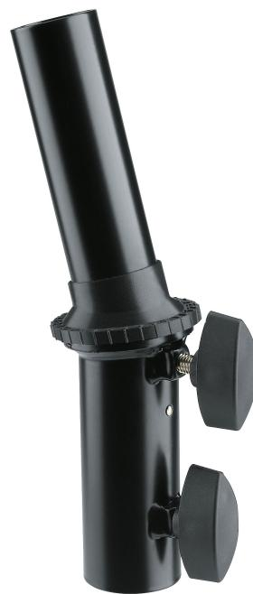
Aufsteckbar auf Boxenstative mit Rohr-Ø 35 mm. Stufenlose Neigung von 0° bis 15°, arretierbar mittels Klemmschraube.
